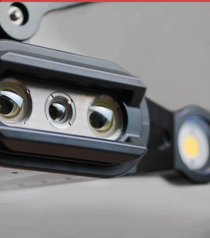
La cámara Hammerhead registra la temperatura y profundidad del agua Créditos: Aquabyte
