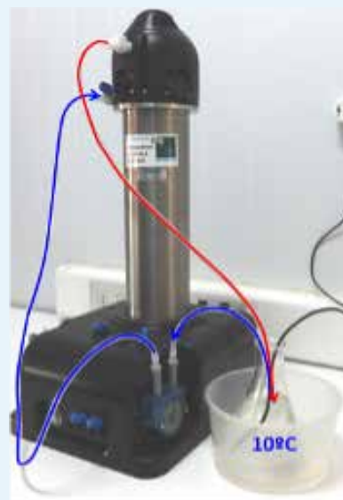
Figura 1. Fluorómetro de Altas Tasas de Repetición (FRRF3)
