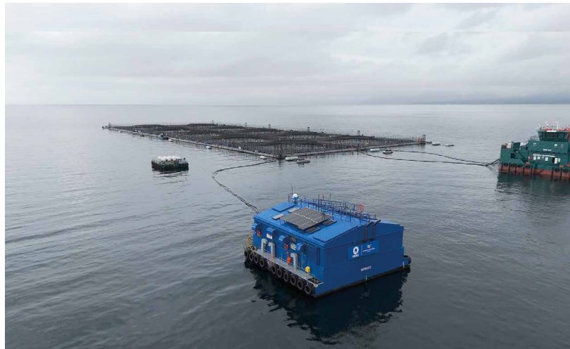
Centros que operaron con Oxymar, el sistema de oxigenación de OXZO, registraron una reducción de 25% en la mortalidad y de 60 días en el tiempo de ciclo, junto con un ahorro de 35% en diésel y una disminución de 0,98% en la huella de carbono. Foto: OXZO
