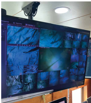
Planta Traiguén 1, Invermar. Sistemas de visión artificial permiten el monitoreo remoto de biomasa y salud de los peces en tiempo real. Créditos: InfoSALMON
